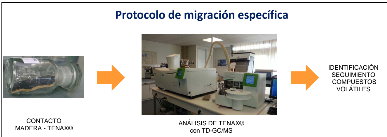
Figura 2: Método con TD-GC/MS para la migración específica de los embalajes de madera de chopo y de pino marítimo
