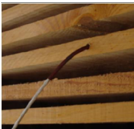
Ilustración 2-1.- Ejemplo de ubicación correcta de una sonda en una tabla.
