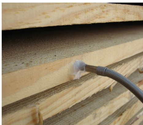
Ilustración 2-5.- Ejemplo de sellado de orificio de sonda.
