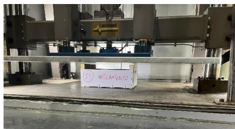
Ensayos a los envases de madera en los laboratorios de AIDIMME
