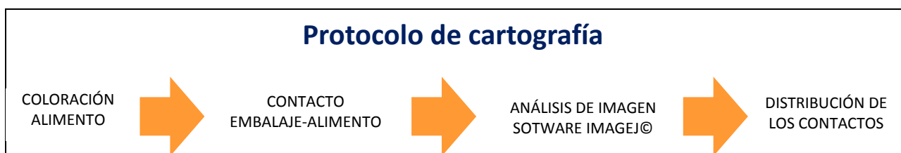
Figura 3: Protocolo de cartografía de contacto «embalaje de madera-alimento»
