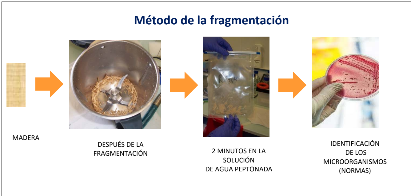
Figura 4: Herramienta de análisis microbiológico para los elementos de madera con menos de 5 mm de grosor: la fragmentación
